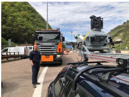
Figura 1. TRIMBLE MX9 montato sull'auto e mezzo di scorta.
