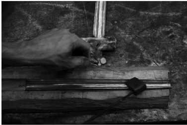
2. stagnatura dei bordi delle lamine e assemblaggio delle due porzioni di tubo
