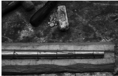
1. realizzazione delle sagome in legno per la modellazione tramite battitura delle lamine
