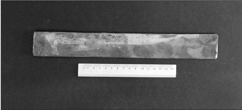
Fig. 14 - Lingotto di forma rettangolare realizzato per fusione (realizzazione e fotografia di Alessandro Ervas).
