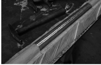
1. realizzazione delle sagome in legno per la modellazione tramite battitura delle lamine
