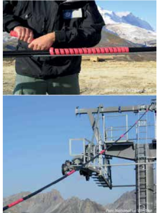
Figura 13: dispositivo di segnalazione montato in Francia sul cavo multicoppia delle seggiovie (foto: OGM - Observatoire des Galliformes de Montagne)
