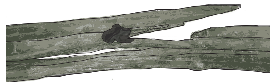
Figur 16.3 Limträbalk med betydande diskontinuitet vid kvist i den tredje lamellen efter brand.
