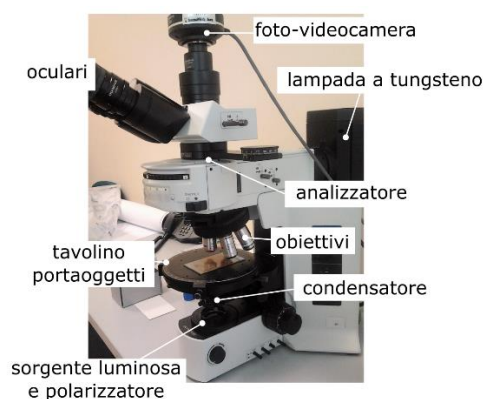
Figura I.2. Microscopio petrografico utilizzato per l'analisi micromorfologica qui presentata con l'indicazione delle componenti principali.
