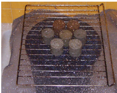
Figura A.1: Provini di terra cruda stabilizzata sottoposti a prova di dilavamento.
