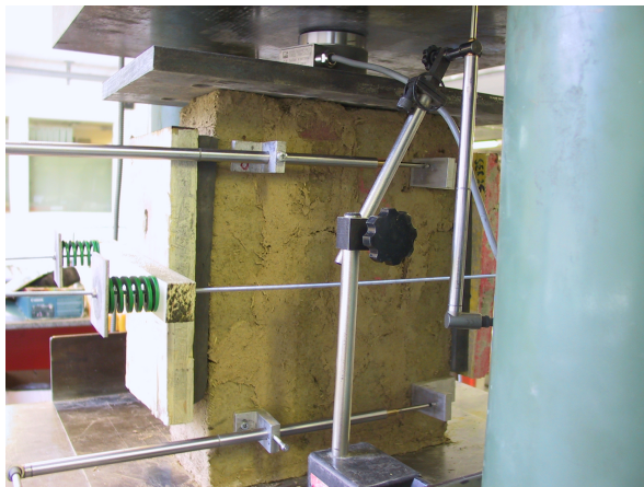
Figura 3.18: Sistema di confinamento laterale per prova di compressione parallela ai letti di malta.
