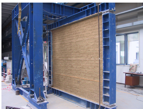
Figura 4.8: Tamponamento in terra cruda con partizioni in legno.
