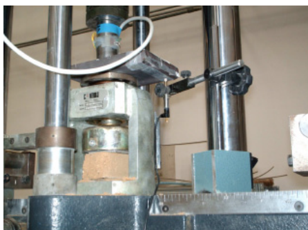
Figura 3.6: Provino di malta in prova di compressione.
