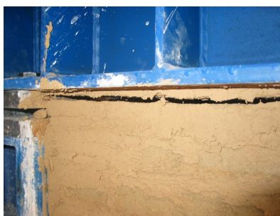
Figura 4.32: Perdita di volume per abrasione in prova ciclica.
