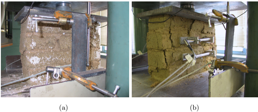
Figura 3.17: Provini di muratura a collasso testati perpendicolarmente ai letti di malta: prova 1 (a) e prova 3 (b).
