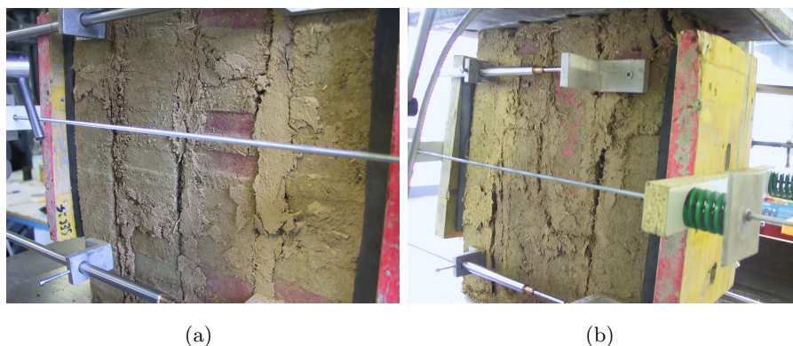
Figura 3.21: Provini di muratura a collasso testati parallelamente ai letti di malta: prova 1 (a) e prova 2 (b).
