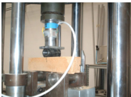
Figura 3.3: Provino di malta in prova a flessione su 3 punti.
