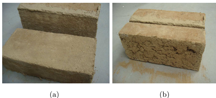
Figura 3.29: Superficie liscia (a) e scabra (b) di mattoni CLM.
