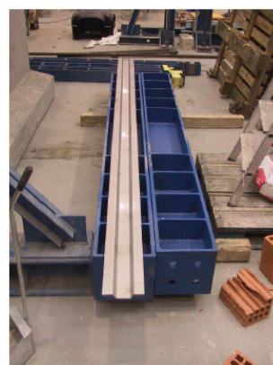
Figura 4.6: Particolare partizione in acciaio inox.
