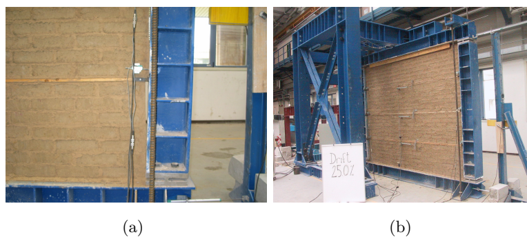
Figura 4.38: Particolare contatto parete-telaio per soluzione partita, per drift = 2,5% (a); situazione finale dopo cicli di drift = 2,5% (b).
