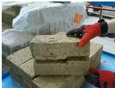
Figura 3.43: Fessurazione a taglio nel letto di malta.
