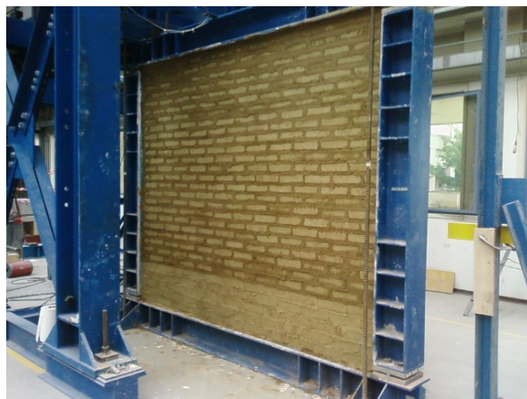
Figura 4.7: Tamponamento in terra cruda costruito secondo tecnica tradizionale.
