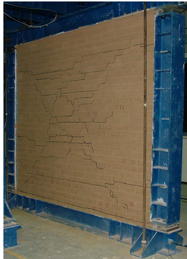
Figura 5.24: Quadro fessurativo/violazione criterio di scorrimento per tamponamento in terra cruda per drift = 2,8%: modello Abaqus con resistenza dei giunti di picco (a) e residua (b) e prova sperimentale (c).
