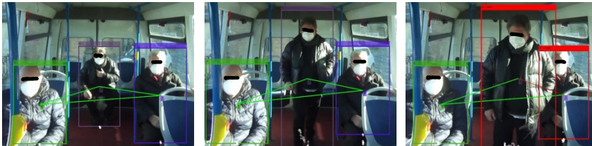
Fig. 13. Detection di utenti all'interno del mezzo di trasporto e valutazione del distanziamento reciproco
