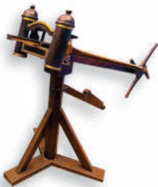
L'“Erzspanngeschütz” dell'ingegnere tedesco Erwin Schramm (1856-1935): ricostruzione ipotetica del χαλκοτονόν (Chalkotonon, pezzo di artiglieria con molla di bronzo) di Filone Alessandrino. Vetrina con ricostruzioni di pezzi di artiglieria meccanica nel Museo del Castello di Saalburg in Assia (Germania). Particolare dalla Foto di SBA73 2007, su Flickr (Artilleria experimental romana a Saalburg). CC SA 2.0, Wikipedia Commons.
