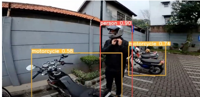
Fig. 1 Riconoscimento automatico di immagini. L'algoritmo YOLOv6 identifica le parti più rilevanti della immagine e le inserisce in un riquadro analizzando il contenuto dello stesso. Viene identificata la categoria con maggiore probabilità (es. Moto e persona).
