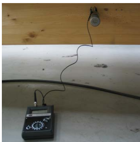
Fig. 8.10 – Rilevamento del contenuto d'acqua della trave
