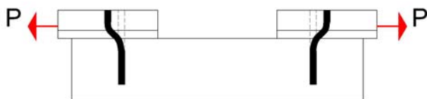
Fig. 11.5 – Modalità di deformazione dei provini
