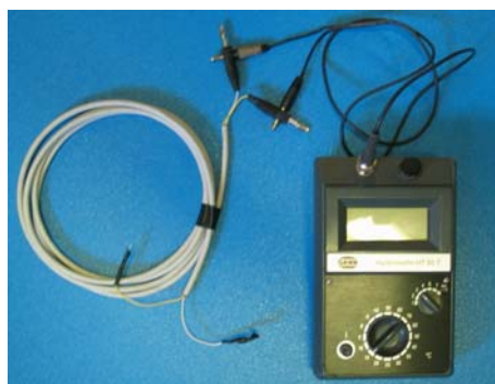
Fig. 10.13 – Strumento per la rilevazione del contenuto d'acqua
