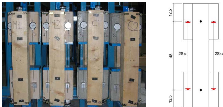
Fig. 11.12 – Posizione dei comparatori per il rilevamento dello scorrimento delle connessioni
