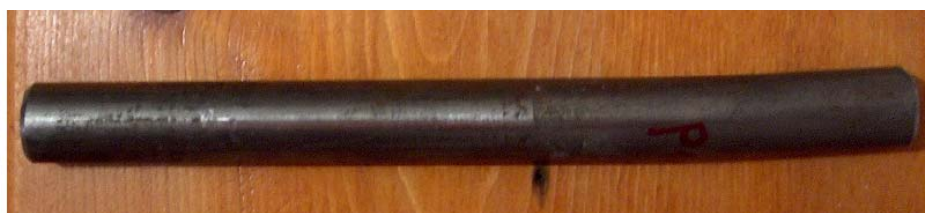
Fig. 8.4 – Connettori in acciaio liscio (Marini et al. 2009, p. 29)
