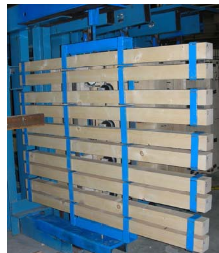
Fig. 9.13 – Prova di flessione di lunga durata su 10 travi in legno di abete
