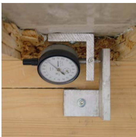
Fig. 8.9 – Comparatore analogico millesimale per il rilevamento dello scorrimento trave-soletta
