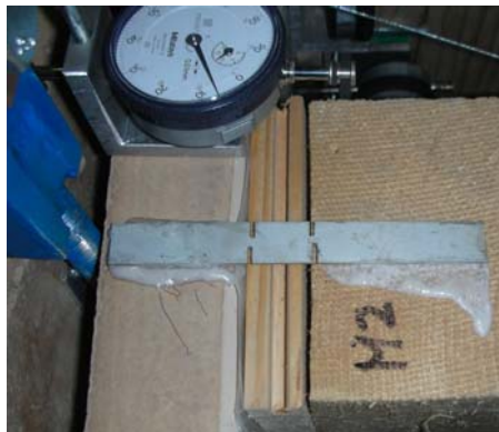
Fig. 11.9 – Piastra in alluminio per il contrasto della rotazione relativa tra soletta e travetto
