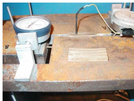
Fig. 10.14 – Spilli per la rilevazione del contenuto d'acqua del campione
