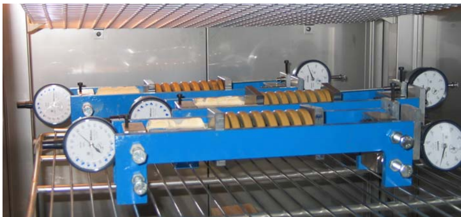
Fig. 10.27 – Campioni in camera climatica al 50% di umidità ambientale relativa
