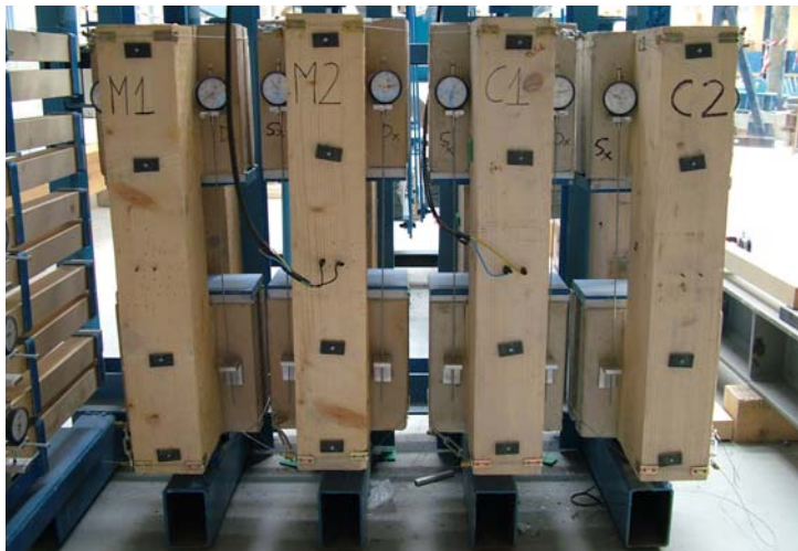
Fig. 11.13 – Prova di taglio di lunga durata su connessioni a piolo legno-calcestruzzo e legno malta di calce naturale
