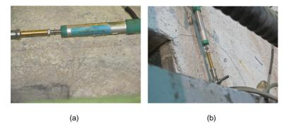
Figure 9.2: Visual damage observations corresponding to (a) DS1, and (b) DS2, respectively
