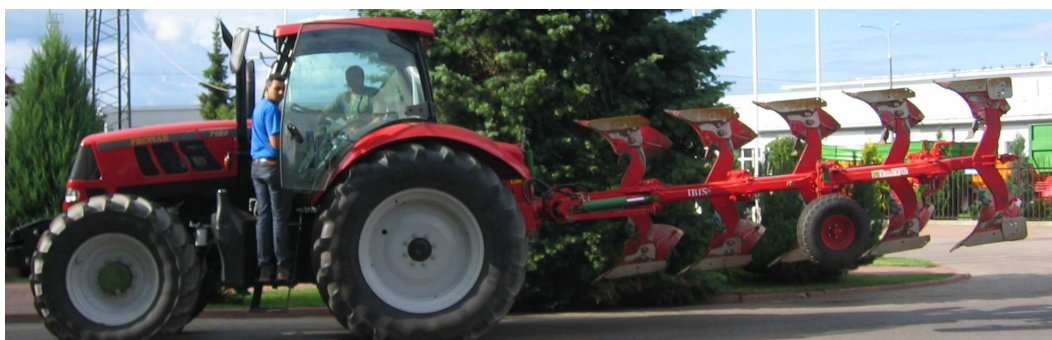
Fig. 41: Mezzo agricolo di test (modello Pronar P6 – 180 hp) attrezzato con aratro e front ballast.
